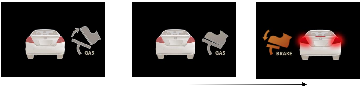
Bild 3: Darstellung auf dem Beifahrerdisplay, wenn der Fahrer Gas gibt (links), wenn er den Fuß vom Gaspedal nimmt (mitte) und bei einem stärkeren Bremsmanöver (rechts).
